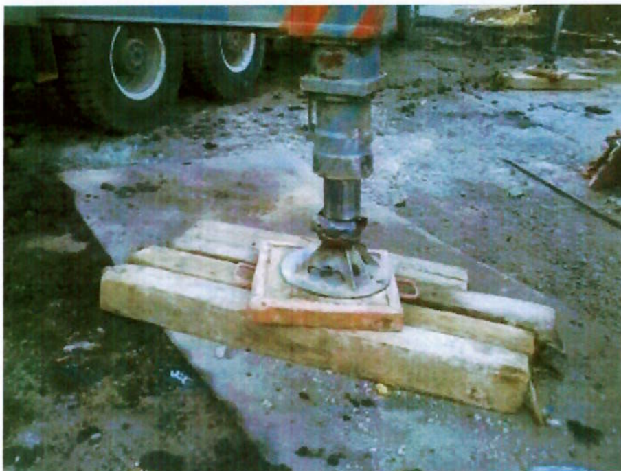
Patolamento com dormentes de madeira e chapa de aço
