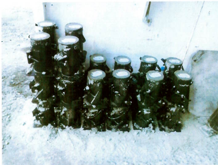
Moldagem de corpos de prova
