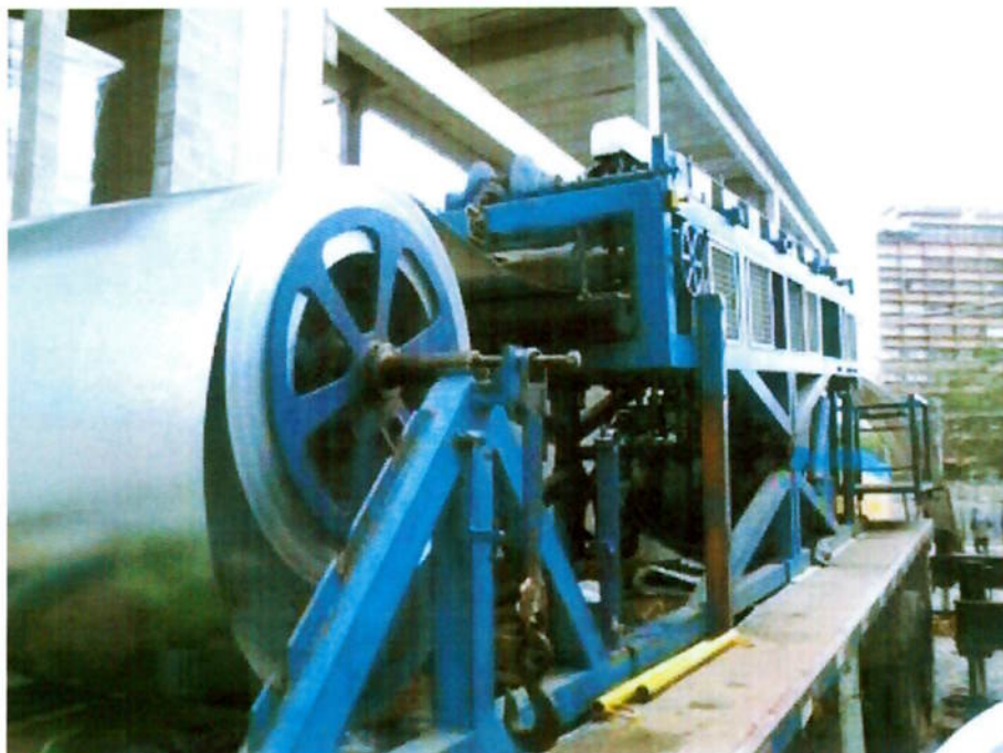
Confecção da telha pela perfiladora
